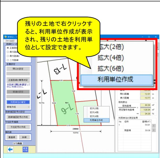
「利用単位の測定結果欄」に利用単位ごとの面積が表示されます。利用単位に選択されていない部分が残っている時は残面積が表示され、すべて選択した時は合計面積(=評価対象地の面積)が表示されます。
