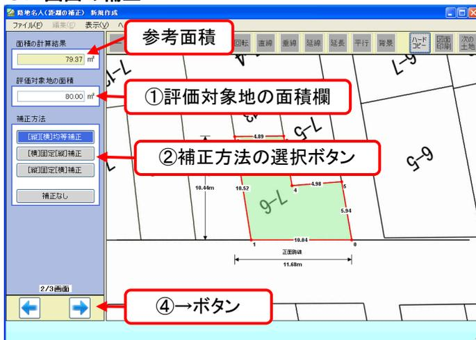
図面上で指定した評価対象地の面積(参考面積)が、実際の面積になるよう図面を補正します。詳しくは15ページをご覧ください。
